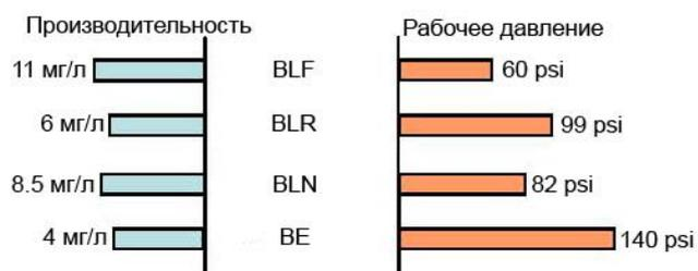
Сравнение мембран низкого давления CSM при условии подачи одинаковой воды (TDS - 500мг/л NaCl) и получении одинакового количества пермеата (25 л/м<sup>2</sup> - час) при температуре 25°C.
