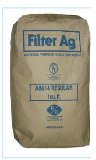
Хотя Filter-Ag не является фильтрующим материалом для удаления железа, практика доказала, что неровная и зубчатая поверхность гранул Filter-Ag очень хорошо улавливает флоккулы железа, которые образуются после окисления растворенного железа. Типичными методами окисления являются аэрация, озонирование и хлорирование.
