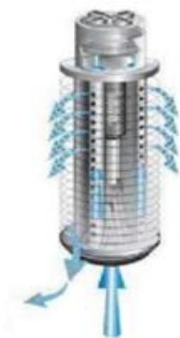
Промывка фильтрующих блоков осуществляется автоматически изменением направления потока воды (изнутри – наружу). Обратный тангенциальный поток воды преодолевает сопротивление пружины, происходит раздвижение дисковых колец и смыв отфильтрованных частиц в канализацию. Время промывки каждого фильтровального блока, как правило, 15 – 30 сек, (в зависимости от степени загрязнения исходной воды). В течение этого промежутка времени в дренаж сбрасывается 30 - 50 л воды.
