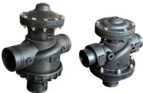
Переключение в режим обратной промывки происходит при помощи двухпозиционного трехходового клапана, которым снабжен каждый фильтровальный блок. Назначение двухпозиционного трехходового клапана - изменение направления потока воды в блоке дискового фильтра, для автоматического выполнения функции обратной промывки.
