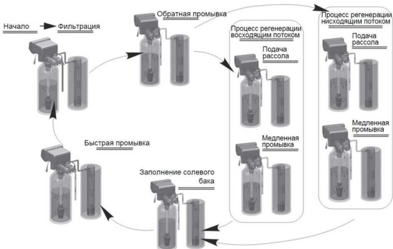
**Фильтрация.** Вода под давлением и с определенной скоростью проходит через фильтрующую загрузку. Очистка от ионов кальция, магния, железа и марганца осуществляется за счет реакции обмена на ионы натрия.
