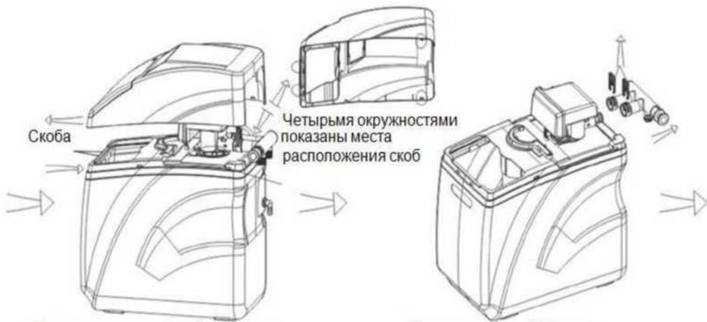
**Снятие пылезащитной крышки.**
