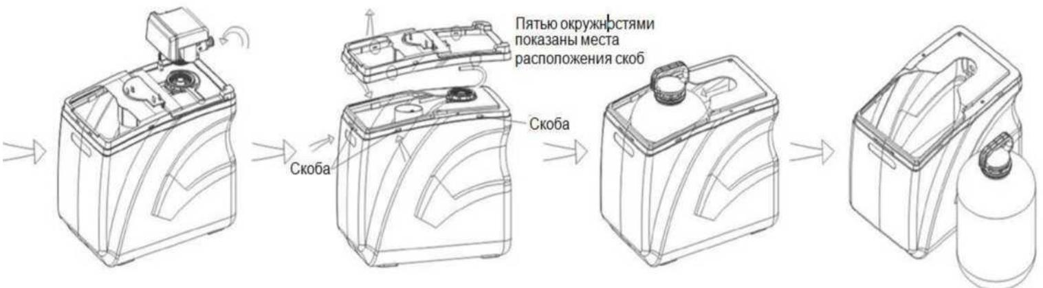
**Снятие управляющего клапана.**
