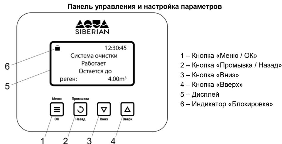
Панель управления клапана включает в себя:
