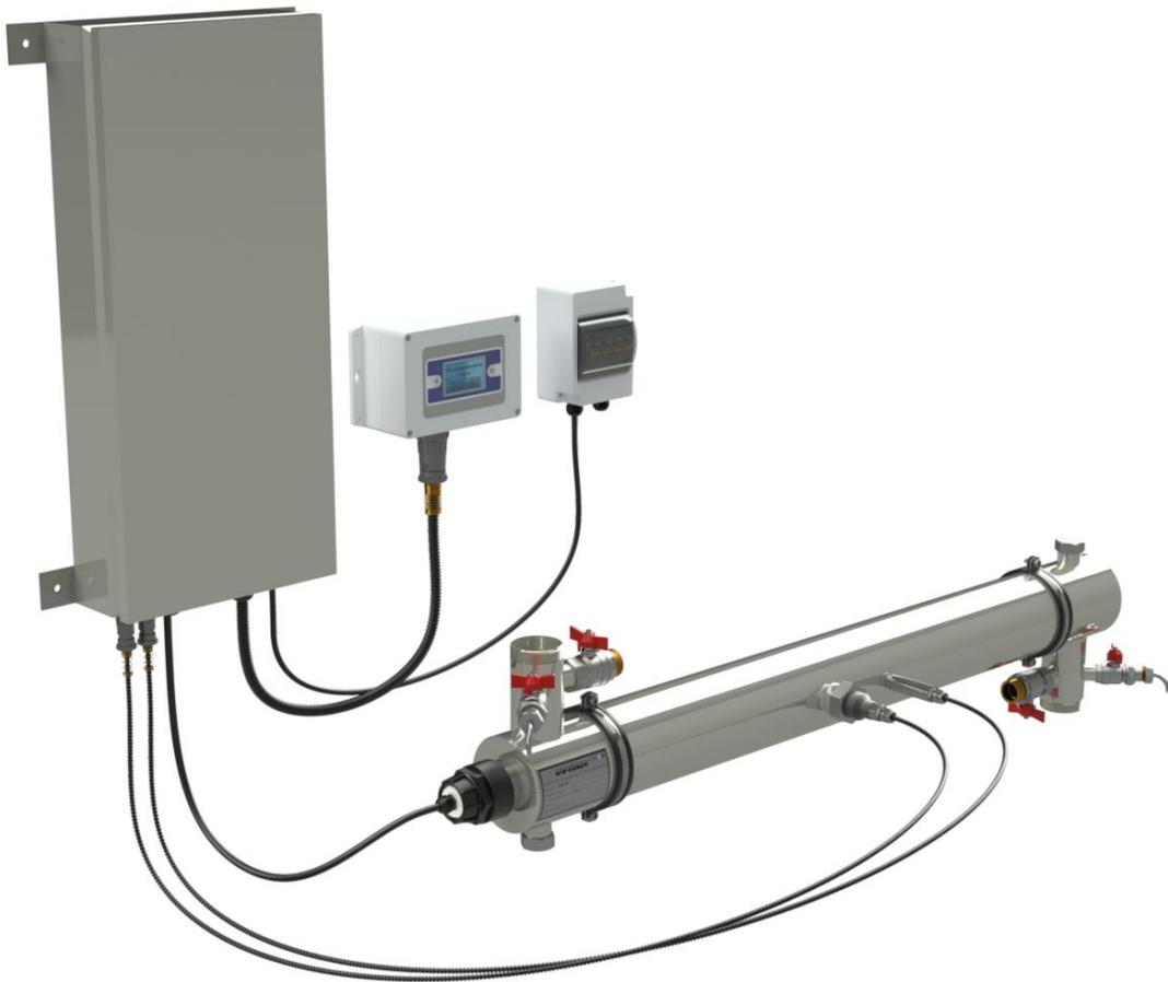
Установка предназначена для ультрафиолетового обеззараживания **питьевой** воды. Условия эксплуатации: в закрытых, отапливаемых, вентилируемых помещениях при температуре окружающего воздуха от +5°C до +35°C и относительной влажности воздуха с верхним значением 80% при +25°C. Температура исходной воды от +1°C до +30°C.
