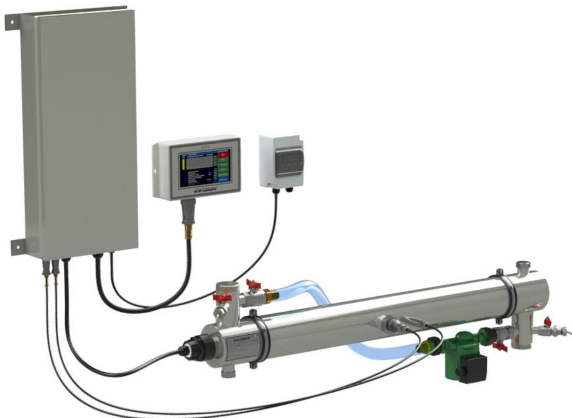
Установка предназначена для ультрафиолетового обеззараживания **питьевой** воды. Условия эксплуатации: в закрытых, отапливаемых, вентилируемых помещениях при температуре окружающего воздуха от +5°C до +35°C и относительной влажности воздуха с верхним значением 80% при +25°C. Температура исходной воды от +1°C до +30°C.
