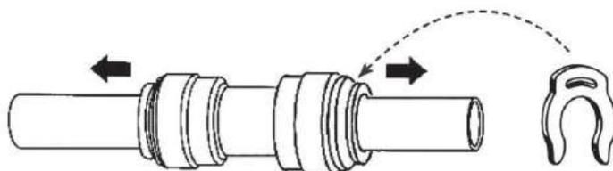
4. Зафиксируйте соединение скобкой.
