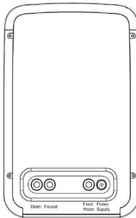
1. Присоедините к фильтру (Feed Water) красную трубку от узла подачи воды.
