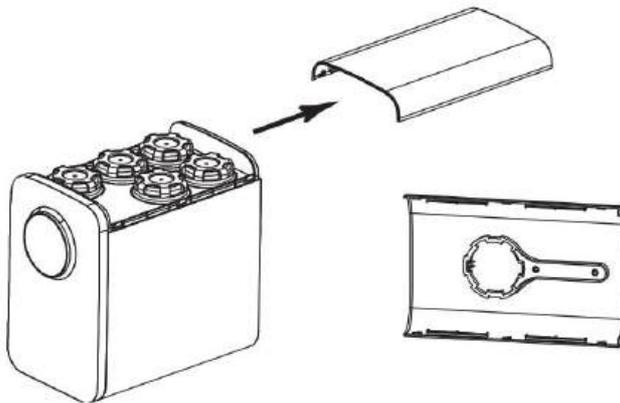
На внутренней стороне панели закреплен пластиковый ключ.
