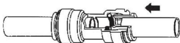
3. Потяните трубку из коннектора для проверки соединения. Трубка не должна выходить из коннектора.
