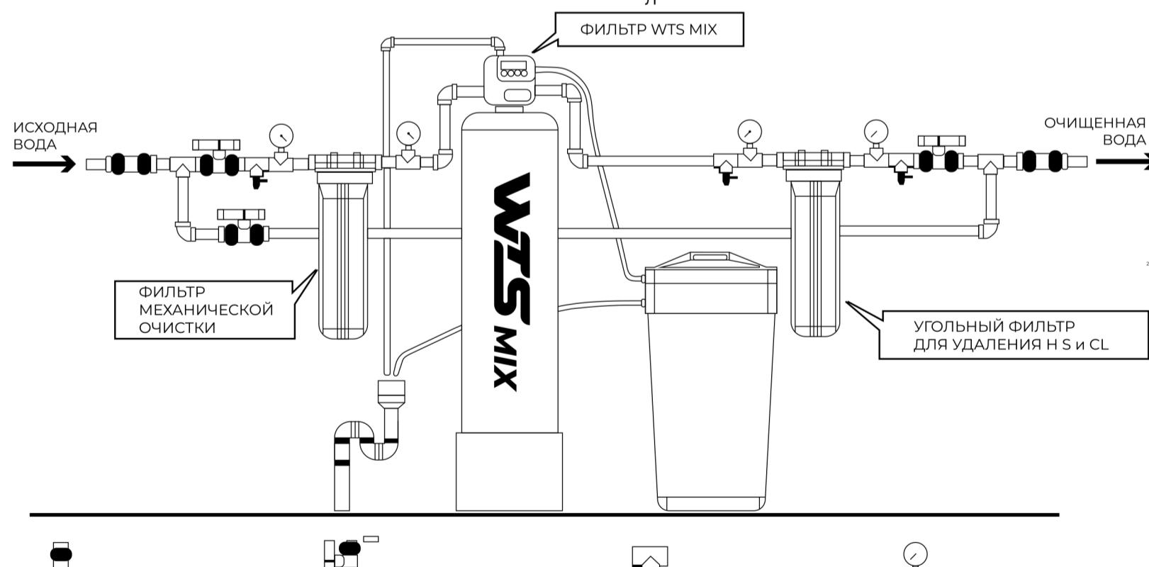
Установите фильтр механической очистки (4,5x20" Big Blue с полипропиленовым картриджем 5-50 мкм) перед системой WTS Mix.
